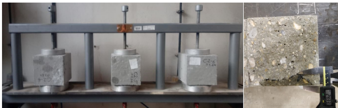
56. ábra: A vízáróság vizsgálat kísérleti összeállítása
