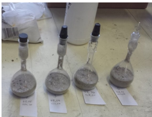
20. ábra: Finom adalékanyag testsűrűségének meghatározásához használt eszközök
