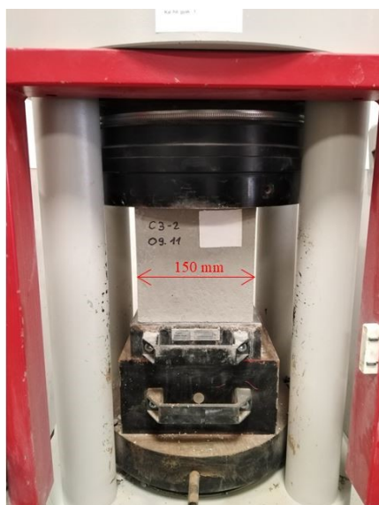
54. ábra: A nyomószilárdsági vizsgálat kísérleti összeállítása
