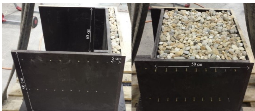
17. ábra: Alkalmazott zsaluzat az első vizsgálati szakaszban (Zs-1): a) 5 cm-es falvastagság, b) 50 cm-es falvastagság
